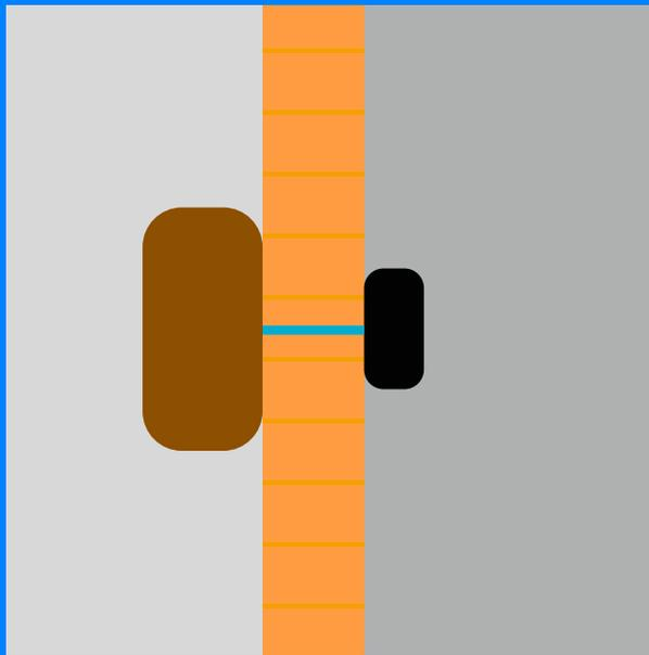
Precisaremos perfurar sua parede externa para conectar uma caixa de conexão externa a uma caixa de conexão interna.
