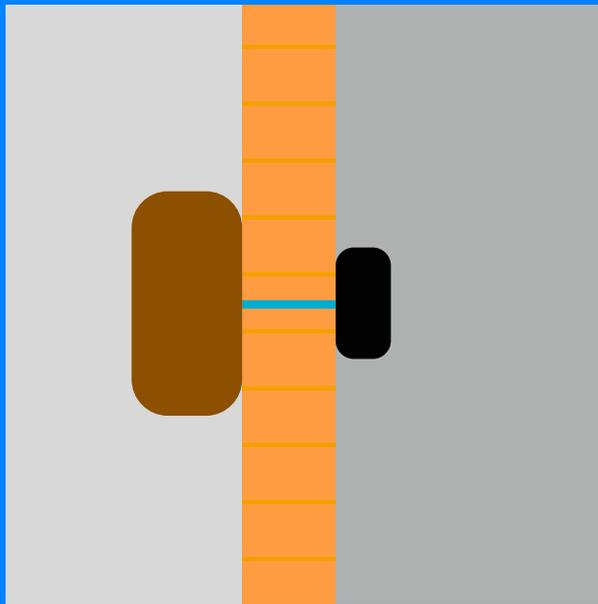
Sarà necessario forare il muro esterno per collegare una scatola di connessione esterna a una interna.
